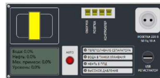
Станция управления сепаратором на SCADA консоли
