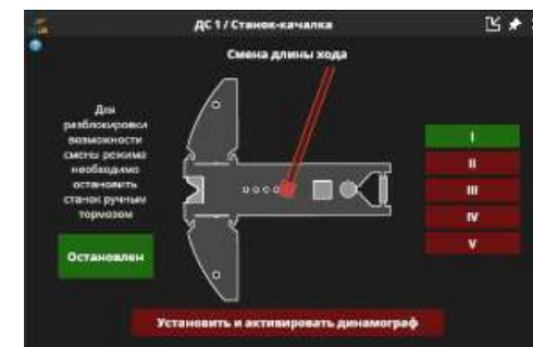
Панель управления станком-качалкой ШСНУ
