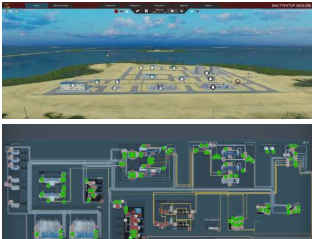
Пример трехмерной сцены и анимированной технологической схемы
